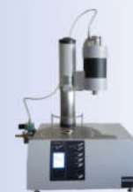
Совмещенный прибор термогравиметрического анализа и дифференциальной сканирующей калориметрии STA 449 F3 JUPITER Combined device of thermogravimetric analysis and differential scanning calorimetry STA 449 F3 JUPITER
